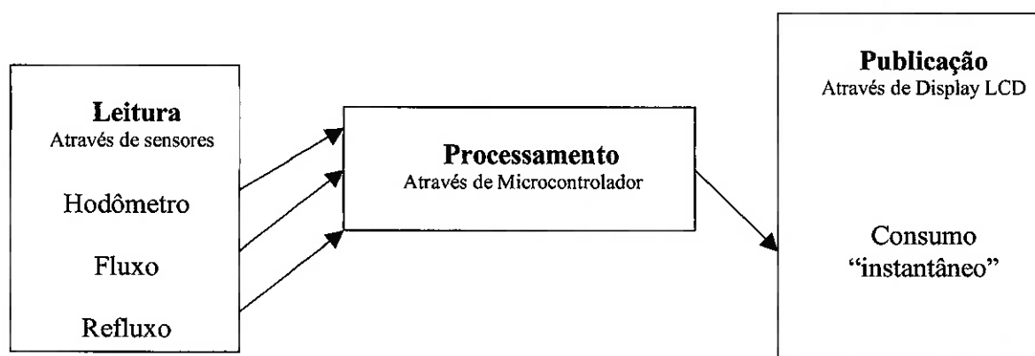
Figura 14: Diagrama de blocos do sistema eletrônico.
